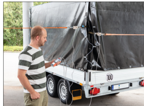
Misurazione di forze in diverse direzioni di trazione o compressione possibile con un solo dispositivo di misurazione
