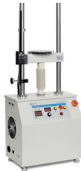
Banco di prova motorizzato incl. misuratore di lunghezza digitale LB
