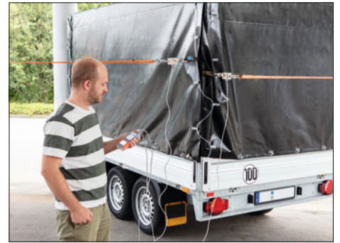
Posibilidad de medir fuerzas en diferentes direcciones de tracción o compresión con un solo instrumento de medición
