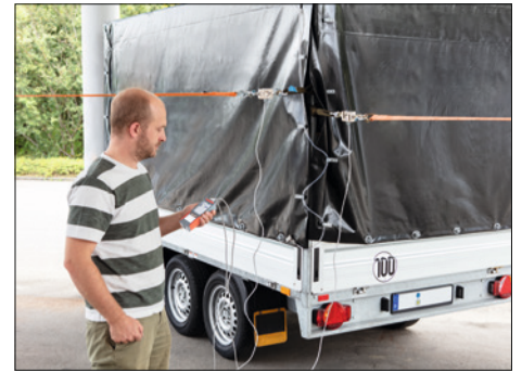
Messen von Kräften in verschiedenen Zug- oder Druckrichtungen mit nur einem Messgerät möglich
