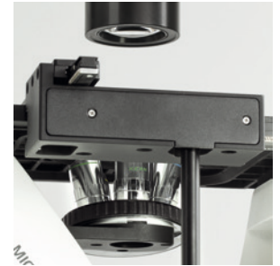
Les boutons coaxiaux de réglage des x/y peuvent être installés à droite ou à gauche
