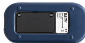
Vista posterior, tapa atornillada del compartimento de la pila
