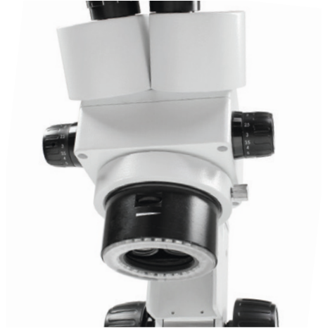
Stufenlos dimmbare integrierte LED-Ringbeleuchtung im Objektivgehäuse
