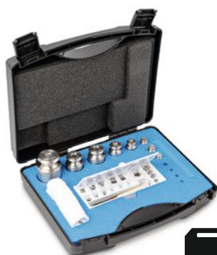
Valigetta imbottita in plastica, per pesi cilindrici a bottone di presa, acciaio tornito
