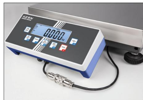
**4** Spina di omologazione, nelle bilance omologate consente di staccare l'apparecchio indicatore dalla piattaforma senza danneggiare l'omologazione, p. es. per il montaggio successivo della bilancia in un tavolo di imballaggio e spedizione, un'intelaiatura per fossa ecc. Si prega di ordinare unitamente alla bilancia
