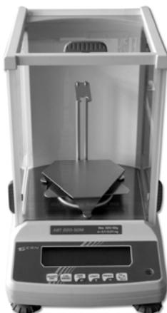
5. Accrocher la plate-forme combinée (cuvette porte-échantillon et tamis) à la potence de la plate-forme de pesée. Veiller à ce que le centrage de la cuvette porte-échantillon du haut s'accroche dans l'évidement de la partie supérieure de la plate-forme de pesée.
