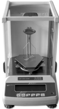
6. Fermer les portes vitrées et brancher l'alimentation en tension de la balance. Attendre la fin du test automatique de la balance et l'affichage sur l'écran de „OFF“ Sur certains modèles est également exécuté un ajustage automatique avant que ne soit affiché „OFF“. (Brancher la balance avec la plate-forme combinée et sans liquide dans le gobelet. )
