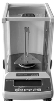
4. Poser au-dessus la plate-forme pour le gobelet sans entrer en contact avec la plate-forme de pesée, comme le montre la figure
